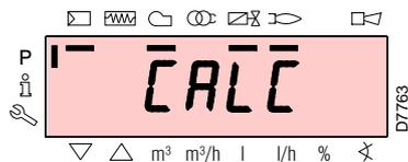
Après le réglage du point «P1» appuyer sur la touche «+», sur l'afficheur s'affiche «CALC» pendant quelques secondes: la boîte de contrôle calculera automatiquement les points de «P2» à «P8», en les distribuant sur une droite, et prenant pour le point «P9» la configuration d'usine (voir le tableau reporté ci dessous). Ils sont théoriques et doivent être vérifiés.
