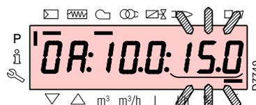
Sélectionner un autre point en appuyant en même temps sur les touches «**+**» et «**-**» (esc).
