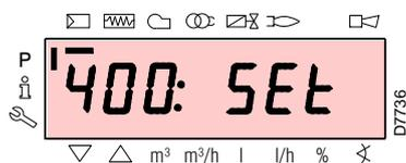
Accéder au niveau paramètres en se reportant à la «*Procédure d'accès par mot de passe*». L'afficheur visualise le groupe paramètres **400**, confirmer avec la touche «**i/reset**».
