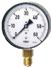
Kapselfedermanometer mit Stahlblechgehäuse 100 mm Durchmesser schwarz. Genauigkeitsklasse 1,6 gemäß EN 837-3/6, überlastsicher bis 1,3 x Skalenendwert. Zur Vermeidung ständiger Druckbelastung ist jeweils ein Druckknopfahh vorzuschalten.
