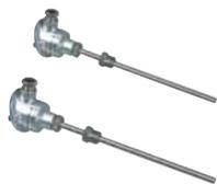
Der Einbausatz beinhaltet zwei Temperaturfühler: Einen für die Ansauglufttemperatur und einen für die der Abgase. Sie müssen an die Anzeige- und Bedieneinheit AZL angeschlossen werden, damit die LMV 52-Regelung den Wirkungsgrad berechnen kann. Der Wert wird am AZL-Display angezeigt.
