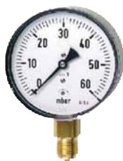
Kapselfederanometer mit Stahlblechgehäuse 100 mm Durchmesser schwarz. Genauigkeitsklasse 1,6 gemäß EN 837-3/6, überlastsicher bis 1,3 x Skalendendwert. Zur Vermeidung ständiger Druckbelastung ist jeweils ein Druckknopfhahn vorzuschalten.
