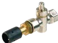
Prüfbrenner rückzündsicher zur Entlüftung der Gasstrecke. Stehender Einbau erforderlich. Ein Druckknopfhahn ist vorzuschalten, wie auf der Abbildung zu sehen. (Druckknopfhahn ist separat zu bestellen)
