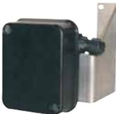
Abhängig vom Stellantrieb des Brenners ist ein dreipoliges Rückführpotentiometer (1000 Ω) für die Positionserfassung des Stellantriebs erforderlich. Erforderlich für den Betrieb mit einem Analog Konverter oder zur Lastrückmeldung
