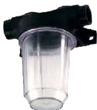
Für die Impulsleitung ist eine Kondensatfalle erforderlich, falls der eigenständige Kondensatrückfluss in den Kessel von der Gasarmatur bis zum Druckanschluss Feuerraum behindert ist. Geeignet für 6 mm Schlauch- oder Rohranschluss.
