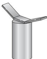
Zur leichteren Wartung wurde eine fahrbare Brennerhalterung entwickelt. Die Höhenausgleichs-Stange ist bauseits beizustellen.
