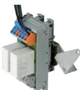
Für die Übertragung zweier zusätzlicher Signale vom Brenner, z.B. „Betrieb“ oder „Störung“ mittels potentialfreier Kontakte steht ein Einbausatz zur Verfügung. Vorkonfektioniert für RS 34-44/64 MZ. Frei einsetzbar für übrige RS Modelle.
