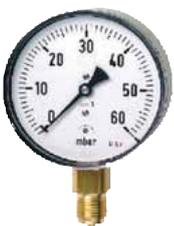
Kapselfederanometer mit Stahlblechgehäuse 100 mm Durchmesser schwarz. Genauigkeitsklasse 1,6 gemäß EN 837-3/6, überlastsicher bis 1,3 x Skalendwert. Zur Vermeidung ständiger Druckbelastung ist jeweils ein Druckknopfhahn vorzuschalten.
