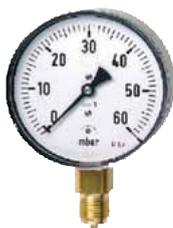
Kapselfederanometer mit Stahlblechgehäuse 100 mm Durchmesser schwarz. Genauigkeitsklasse 1,6 gemäß EN 837-3/6, überlastsicher bis 1,3 x Skalendwert. Zur Vermeidung ständiger Druckbelastung ist jeweils ein Druckknopfahn vorzuschalten.
