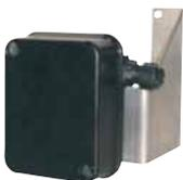
Für den Stellantrieb des Brenners ist bei Bedarf ein dreipoliges Rückführpotentiometer (1000 Ω) für die Positionserfassung des Stellantriebs lieferbar. Erforderlich für den Betrieb eines Konverters für analoges Signal oder zur Lastrückmeldung an übergeordnete Systeme.
