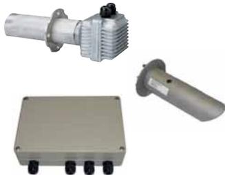
Die QGO<sub>2</sub> ist ein Sauerstoffanalysator mit entsprechendem Fühler, der den Restsauerstoffgehalt in den Abgasen regelt und überwacht. Bestehend aus Sonde, Tauchhülse und PLL-Elektronikmodul.
