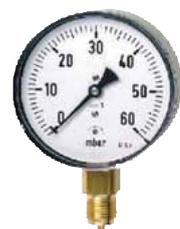
Kapselfedermanometer mit Stahlblechgehäuse 100 mm Durchmesser schwarz. Genauigkeitsklasse 1,6 gemäß EN 837-3/6, überlastsicher bis 1,3 x Skalendendwert. Zur Vermeidung ständiger Druckbelastung ist jeweils ein Druckknopfahnh vorzuschalten.
