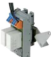
Für die Übertragung zweier zusätzlicher Signale vom Brenner, z.B. „Betrieb“ oder „Störung“ mittels potentialfreier Kontakte steht ein Einbausatz zur Verfügung. Für die u.g. Modelle steckerfertig. Alle anderen Modelle sind bauseits zu verdrahten.
