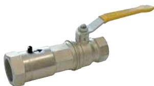
Gas-Kugelhahn mit thermisch auslösendem Sicherheitsventil nach DIN 3357 zum Schutz im Brandfall. DVGW-geprüft.
