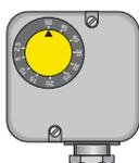
Bei Bedarf kann ein Maximal-Gasdruckwächter installiert und einfach mittels Steckverbinder angeschlossen werden. Dies ist insbesondere für Anwendungen im Bereich der TRD (Dampfkessel) notwendig – FS2 Version. (Serie bei Brennern ab Modell RS 45/E BLU)
