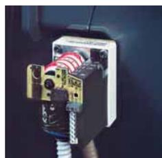
Bei Einsatz des Analog-Signalkonverters wird für dessen Betrieb ein Rückführpotentiometer benötigt. Soll eine Meldung über die Position des Stellmotors aus dem Brenner geführt werden, muss statt des einfachen Rückführpotentiometers ein Doppel-Potentiometer eingesetzt werden.
