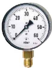
Kapselfedermanometer mit Stahlblechgehäuse 100 mm Durchmesser schwarz. Genauigkeitsklasse 1,6 gemäß EN 837-3/6, überlastsicher bis 1,3 x Skalendwert. Zur Vermeidung ständiger Druckbelastung ist jeweils ein Druckknopfahn vorzuschalten.
