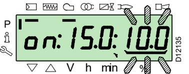
Wählen Sie einen anderen Punkt oder verlassen Sie die Funktion durch gleichzeitiges Betätigen der Tasten "+" und "-" (ESC).
