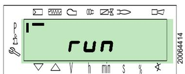
Mit der Taste "i/reset" bestätigen. Der Brenner startet. Das Display zeigt der Reihe nach alle Phasen und entsprechenden Zeiten an. Die Phasen sind im Abschnitt Liste der Phasen (Gasbetrieb) aufgelistet.
