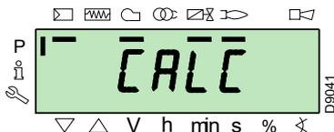
Das Steuergerät wird automatisch die gleichen Werte angeben, die unter den Punkten "P0" und "P1" bis zu den Punkten von "P2" bis "P8" eingestellt sind.
