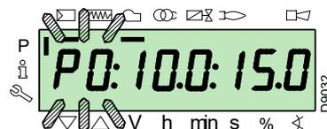
Halten Sie für den Stellantrieb des Brennstoffs die Taste "F" gedrückt (die Position in Grad blinkt) und drücken Sie die Tasten "+" oder "-", um den Wert zu erhöhen oder zu verringern.
