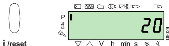
Betätigen Sie die Taste "+" und erhöhen Sie den Wert auf 25 s (blinkt). Betätigen Sie zum Bestätigen und Speichern die Taste "i/reset".
