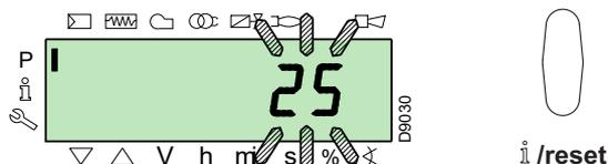
Betätigen Sie, um zur Parameterliste zurückzuschalten, gleichzeitig die Tasten "+" und "-" (ESC).
