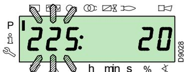
Betätigen Sie, wenn der Wert nicht angezeigt wird, die Taste "i/reset" für eine Dauer von 1 bis 3 s.
