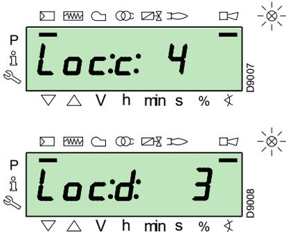
Betätigen Sie zum Entstören die Taste "i/reset" für 1s: auf dem Display erscheint "rESEt". Beim Loslassen der Taste verlöschen die Störungsmeldung und die rote Kontrollleuchte. Das Steuergerät ist entstört.
