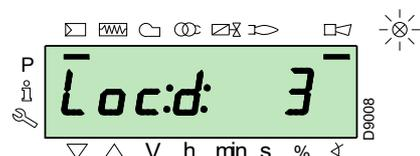
Das Display zeigt abwechselnd einen Code und eine Diagnose des Fehlers an, wobei das System nicht in einen sicheren Zustand versetzt wird.
