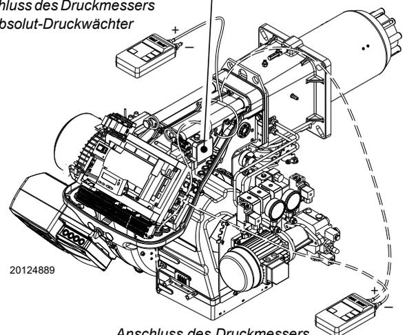
*Anschluss des Druckmessers mit Differential-Druckwächter*
