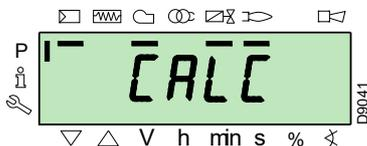
Das Steuergerät wird automatisch die Punkte von "P8" bis "P2" berechnen, und sie auf einer Geraden verteilen. Diese Daten sind theoretisch und müssen geprüft werden.
