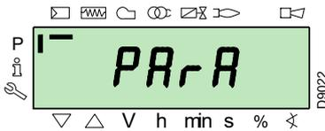
Wählen Sie die gewünschte Parametergruppe mit den Tasten “+” und “-”, und bestätigen Sie durch Drücken der Taste “i/reset”.
