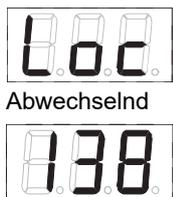
**Am Ende des Rücksetzvorgangs befindet sich die Einheit automatisch in der Position der Störabschaltung (LOC 138) und muss freigeschaltet werden, damit sie in Betrieb gesetzt werden kann!**
