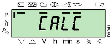
Das Steuergerät berechnet automatisch die Punkte von „P8“ bis „P2“ und verteilt sie auf einer geraden Linie. Sie sind theoretisch und müssen überprüft werden.
