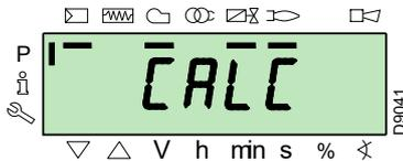
Das Steuergerät wird automatisch die gleichen Werte, die unter den Punkten „P0“ und „P1“ eingestellt wurden, an den Punkten „P2“ bis „P8“ ansetzen.
