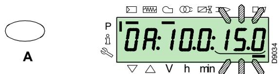
Um die Geschwindigkeit des Umrichters (ausgedrückt in %, d. h. 50 Hz = 100 %) einzustellen, die Tasten „F“ und „A“ gleichzeitig gedrückt halten, die Position in Prozent blinkt, dann die Taste „+“ oder „-“ drücken, um den Wert zu erhöhen oder zu verringern.
