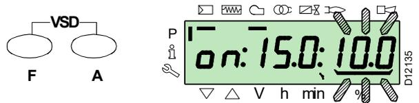
Einen anderen Punkt auswählen oder den Vorgang durch gleichzeitiges Drücken der Tasten „+“ und „-“ (**ESC**) beenden.
