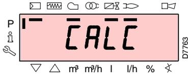
Betätigen Sie nach Einstellung von Punkt "P1" die Taste "+". Auf dem Display erscheint kurzzeitig "CALC": das Steuergerät berechnet automatisch die Punkte von "P2" bis "P8", durch Verteilung auf einer Geraden und Annahme der Werkseinstellung für Punkt "P9" (siehe in nachstehender Tabelle). Diese Daten sind theoretisch und müssen geprüft werden.
