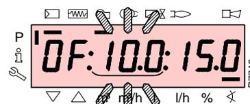
Halten Sie für den Stellmotor des Brennstoffs die Taste "F" gedrückt (die Position in Grad blinkt) und drücken Sie die Tasten "+" oder "-", um den Wert zu erhöhen oder zu verringern.
