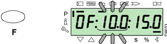
Halten Sie für den Stellmotor der Luft die Taste "A" gedrückt (die Position in Grad blinkt) und drücken Sie die Tasten "+" oder "-", um den Wert zu erhöhen oder zu verringern.
