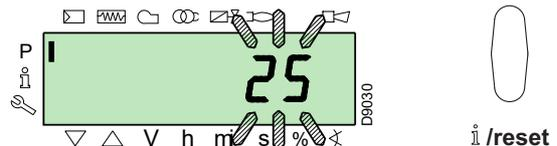
Betätigen Sie, um zur Parameterliste zurückzuschalten, gleichzeitig die Tasten "+" und "-" (ESC).
