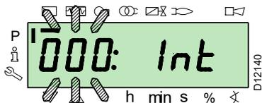
Der Parameter **000** blinkt, mit der Taste "i/reset" bestätigen:
