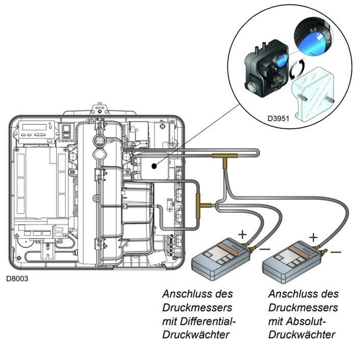
Anschluss des Druckmessers mit Differential-Druckwächter
