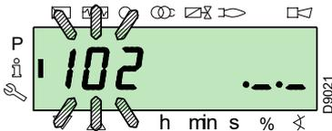
Betätigen Sie, wenn der Wert nicht angezeigt wird, die Taste **"i/reset"** für eine Zeit zwischen 1 bis 3 s.
