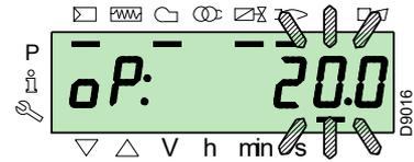
Halten Sie die Taste "F" gedrückt und erhöhen bzw. verringern Sie mit den Tasten "+" oder "-" den Lastanteil.
