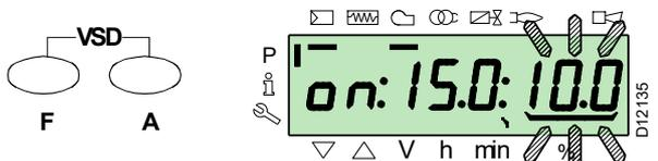
Wählen Sie einen anderen Punkt oder verlassen Sie die Funktion durch gleichzeitiges Betätigen der Tasten "+" und "-" (**ESC**).
