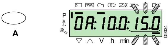
Für die Einstellung der Invertergeschwindigkeit (ausgedrückt in % d. h. 50 Hz = 100 %), halten Sie die Tasten "F" und "A" gleichzeitig gedrückt, die Position in Prozenten ausgedrückt blinkt, drücken Sie die Tasten "+" oder "-", um den Wert zu erhöhen oder zu verringern.
