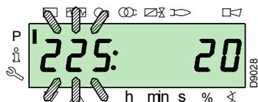
Betätigen Sie, wenn der Wert nicht angezeigt wird, die Taste "i/reset" für eine Zeit zwischen 1 bis 3 s.
