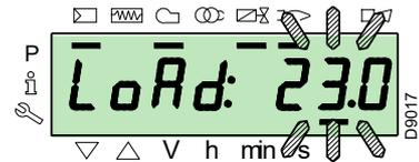
Betätigen Sie, um die Betriebsart zu verlassen, gleichzeitig die Tasten "+" und "-" (ESC) für 3 s: der Brenner arbeitet automatisch und die Leistung ist vom Thermostat/Regeldruckwächter (TR) abhängig.
