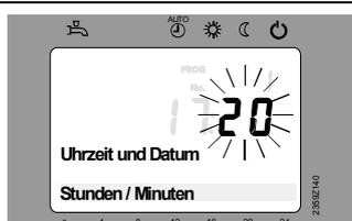
In der Anzeige werden die Minuten blinkend dargestellt. Drehen Sie den Drehknopf bis der Minutenwert der Uhrzeit richtig eingestellt ist.
