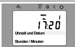
Die Einstellung ist abgespeichert, die Anzeige blinkt nicht mehr. Sie können direkt mit weiteren Einstellungen fortfahren oder, drücken Sie die Betriebsarttaste um in die Grundanzeige zu gelangen.
