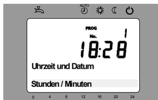
Im unteren Bereich der Anzeige erscheint die erste Bedieneite der Bedieneite *Uhrzeit und Datum*. Drehen Sie den Drehknopf bis zur Bedieneite *Stunden / Minuten*.
