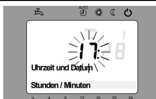
In der Anzeige werden die Stunden blinkend dargestellt. Drehen Sie den Drehknopf bis der Stundenwert der Uhrzeit richtig eingestellt ist.
