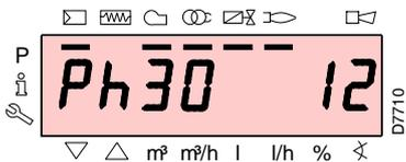
Das Display zeigt die verschiedenen Anfahren-, Ein- und Ausschaltphasen des Brenners an. Im nebenstehenden Beispiel zeigt das Display an, dass sich der Brenner in Phase 30 befindet (siehe im Diagramm von Abb. 32) und 12 s bis zum Übergang zur nächsten Phase fehlen.
