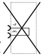
In caso di applicazione del Kit RWF40, nella spina X4 non collegare il termostato TR. Sostituire il termostato TL con un ponte ai morsetti T1 e T2 della X7. I morsetti T6, T7, T8 della X4 devono rimanere NON COLLEGATI. Per connettere il Kit RWF40 eliminare la spina X9.
