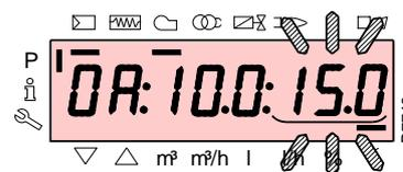
Halten Sie für den Stellmotor der Luft die Taste "A" gedrückt (die Position in Grad blinkt) und drücken Sie die Tasten "+" oder "-", um den Wert zu erhöhen oder zu verringern.
