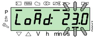
Betätigen Sie, um die Betriebsart zu verlassen, gleichzeitig die Tasten "+" und "-" (ESC) für 3 s: der Brenner arbeitet automatisch und die Leistung ist vom Thermostat/Regeldruckwächter (TR) abhängig.
