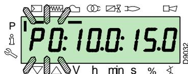
Halten Sie für den Stellmotor des Brennstoffs die Taste "F" gedrückt (die Position in Grad blinkt) und drücken Sie die Tasten "+" oder "-", um den Wert zu erhöhen oder zu verringern.
