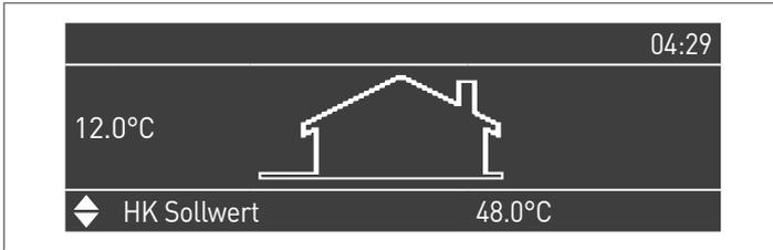
Die Außentemperatur wird in der linken Anzeige angegeben. Dieser Wert wird nur angezeigt, wenn der Außenfühler (Zubehör) angeschlossen ist.
