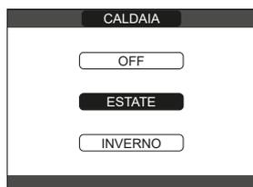
**INVERNO** / : selezionando nel menù STATO  $\rightarrow$  CALDAIA  $\rightarrow$  INVERNO si attivano le funzioni di riscaldamento e acqua calda sanitaria. Sul REC10CH viene normalmente visualizzata la temperatura dell'acqua sanitaria a meno che non sia in corso una richiesta di riscaldamento, nel qual caso viene visualizzata la temperatura di mandata della caldaia.
