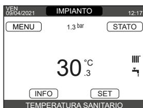
**ESTATE** : selezionando nel menù STATO  $\rightarrow$  CALDAIA  $\rightarrow$  ESTATE si attivano le funzioni tradizionali di sola acqua calda sanitaria. Sul REC10CH viene normalmente visualizzata la temperatura dell'acqua sanitaria erogata dalla caldaia.
