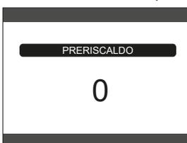
**TOUCH & GO:** se non si desidera lasciare la funzione PRERISCALDO sempre attiva e si necessita di acqua calda pronta subito, è possibile effettuare il preriscaldamento dell'acqua sanitaria solo pochi istanti prima del prelievo. Impostare il parametro PRERISCALDO = 2 per attivare la funzione Touch & Go. Tale funzione consente, aprendo e chiudendo il rubinetto, di attivare il preriscaldamento istantaneo, che predispone l'acqua calda solo per quel prelievo.
