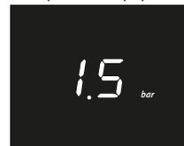
NOTA: se la pressione di rete è inferiore a 1 bar, mantenere aperto il rubinetto di riempimento (A) durante il ciclo di sfiato e chiuderlo una volta terminato.
