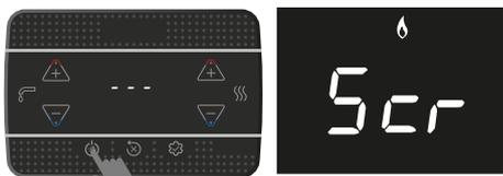
Una volta attivata, la funzione assume priorità massima; in caso di interruzione e ripristino di alimentazione elettrica, la funzione viene ripresa da dove era stata interrotta.
