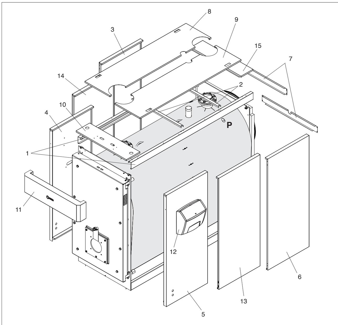
⚠ Utiliser le doigt de gant en cuivre (P) pour l'introduction des bulbes/sondes des dispositifs de sécurité.
