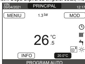
Pentru a activa modul CONFORT, evidențiați temperatura utilizând tastele „+” și „-”. După confirmarea selecției prin apăsarea butonului ENTER, valoarea temperaturii va începe să fie afișată intermitent. Apăsați tastele „+” și „-” pentru a modifica temperatură în trepte de 0,5°C. După confirmarea selecției, se va afișa un nou ecran, care va solicita utilizatorului să seteze durata modului CONFORT.
