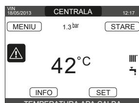
Deplasați-vă pe ecran până când evidențiați pictograma. Se va afișa mesajul de eroare. Ecranul de descriere a defecțiunilor este afișat automat după ce timpul de iluminare a afișajului a trecut, fără apăsarea niciunui buton.
