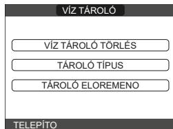
**TÁROLÓ TÍPUS:** Ez a paraméter lehetővé teszi a víztartály típusának beállítását. Állítsa az érteket 1-re szondás víztartály kiválasztásához, állítsa az érteket 0-ra víztartály kiválasztásához termosztáttal (gyári beállítás).
