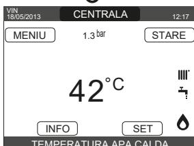
Centrala termică va fi în funcționare până la atingerea temperaturii selectate, după care va fi din nou în „așteptare” menținând temperatură pe tur afișată. În cazul aparției defectiunilor la apindere sau la funcționare, centrala termică execută o „OPRIRE DE SIGURANȚĂ”: pe REC10CH se va afișa triunghiul care indică defectiuni. Pentru a identifica codurile de defectiune și pentru a reseta centrala termică, consultați secțiunea „4.14 Lumini și defectiuni”.
