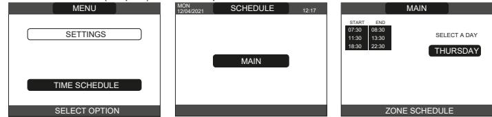
Programmierung: Es ist möglich, für jeden Wochentag bis zu 4 Zeiträume einzustellen, die durch eine Start- und eine Endzeit gekennzeichnet sind. **Anmerkung:** Für Einzelheiten zur Verwendung der Zeitprogrammierung siehe BEDIENUNGSANLEITUNG der REC10CH.
