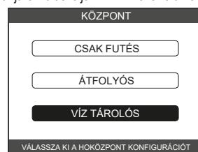
Miután az irányított folyamat véget ért, a REC10CH visszatér a kezdő képernyőoldalra. Ezután folytassa a kazán újraprogramozásával, végezze el a „4.2 A kazán programozása” fejezetben leírt műveleteket.
