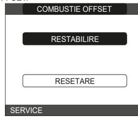
**RESTABILIRE**: selectați această opțiune când înlocuiți placă electronică DE LA AKM
