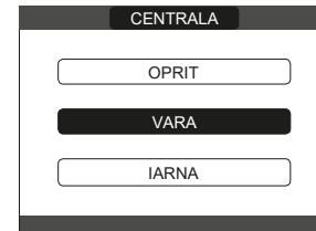
**👁️ IARNA** : selectați STARE  $\rightarrow$  CENTRALA  $\rightarrow$  IARNA pentru a activa funcțiile de încălzire și apă caldă menajeră. În mod normal, REC10CH afișează temperatura apei calde menajere, cu excepția cazului în care există o solicitare de încălzire în desfășurare, caz în care este afișată temperatura de ieșire a centralei termice.
