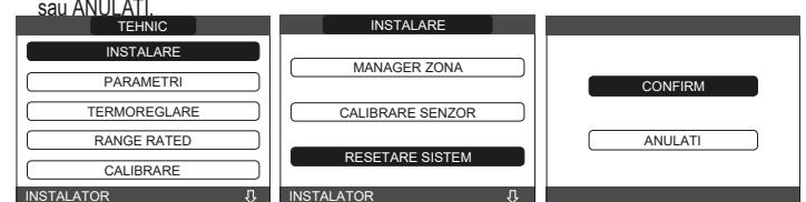
**Observație:** După o resetare, este necesară efectuarea unei noi configurații a sistemului; pentru detalii despre această procedură, consultați secțiunea următoare.
