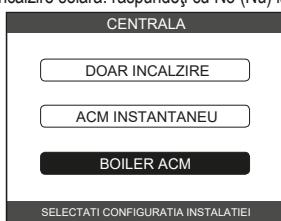
După ce procedura ghidată se încheie, REC10CH va accesa ecranul initial. Apoi continuați cu reprogramarea centralei termice, efectuând operațiile descrise în secțiunea „4.2 Programarea centralei termice”.
