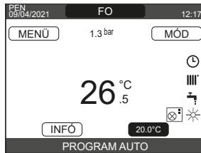
A KOMFORT üzemmód aktiválásához jelölje ki a hőmérsékletet a „+” és „-“ gombokkal. Miután a kiválasztást az ENTER gomb megnyomásával megerősítette, a hőmérséklet értéke villogni kezd. Nyomja meg a „+” és „-“ gombokat a hőmérséklet 0,5 °C-os lépésekben történő módosításához.
