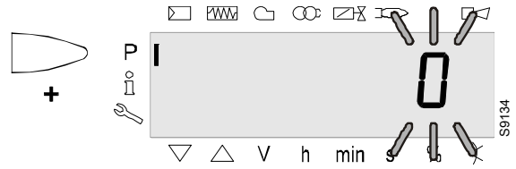
按 将数值向左移动一位。 显示：数值 0 闪烁。 注意： 要检测显示故障，将数值向左移动一位。
