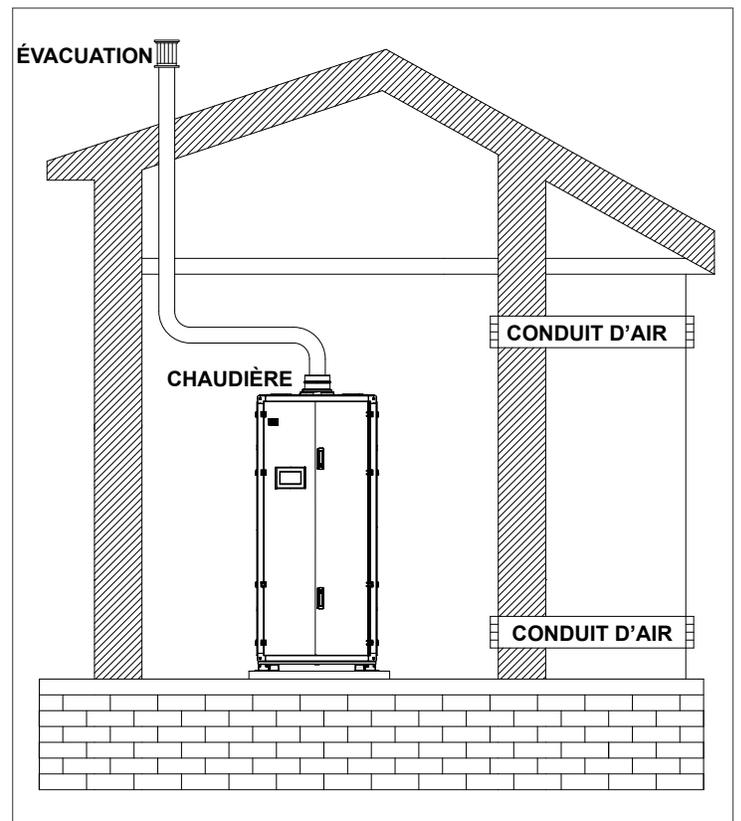
Fig. 38 *Tout l'air de combustion provient de l'extérieur par des conduits horizontaux*
