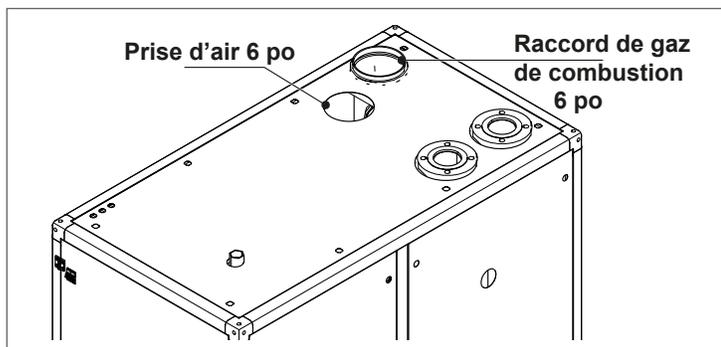
Fig. 33 Raccords d'air de combustion et de gaz de combustion des chaudières AR 1000 et AR 1500
