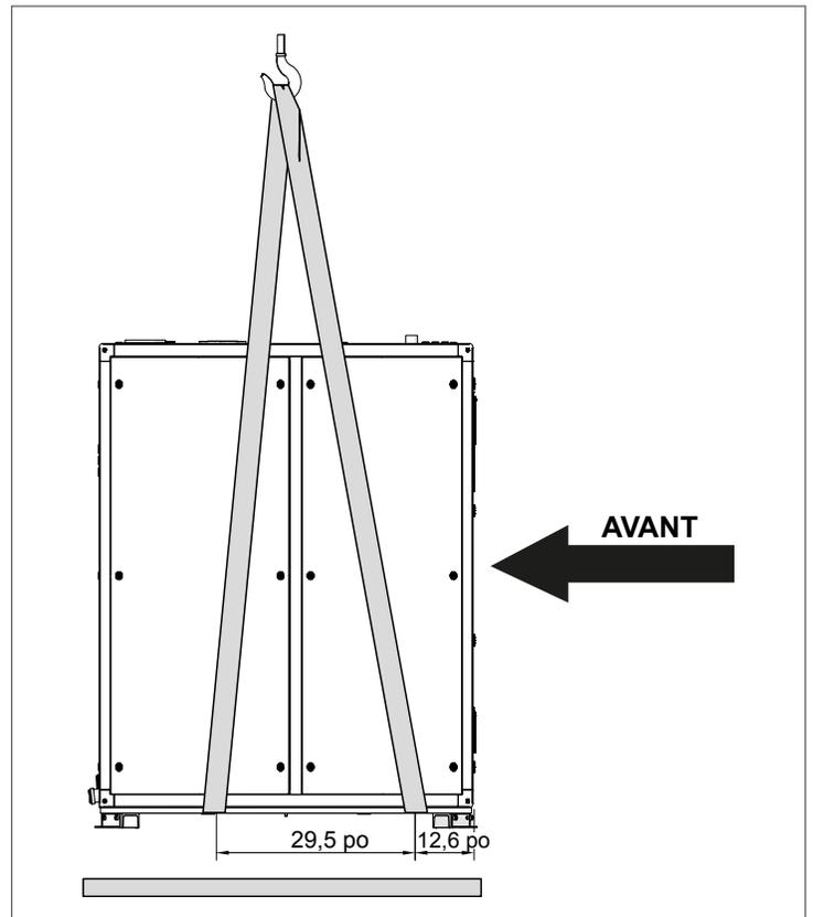
Fig. 7 Manutention lors du levage par grue du modèle AR 2000
