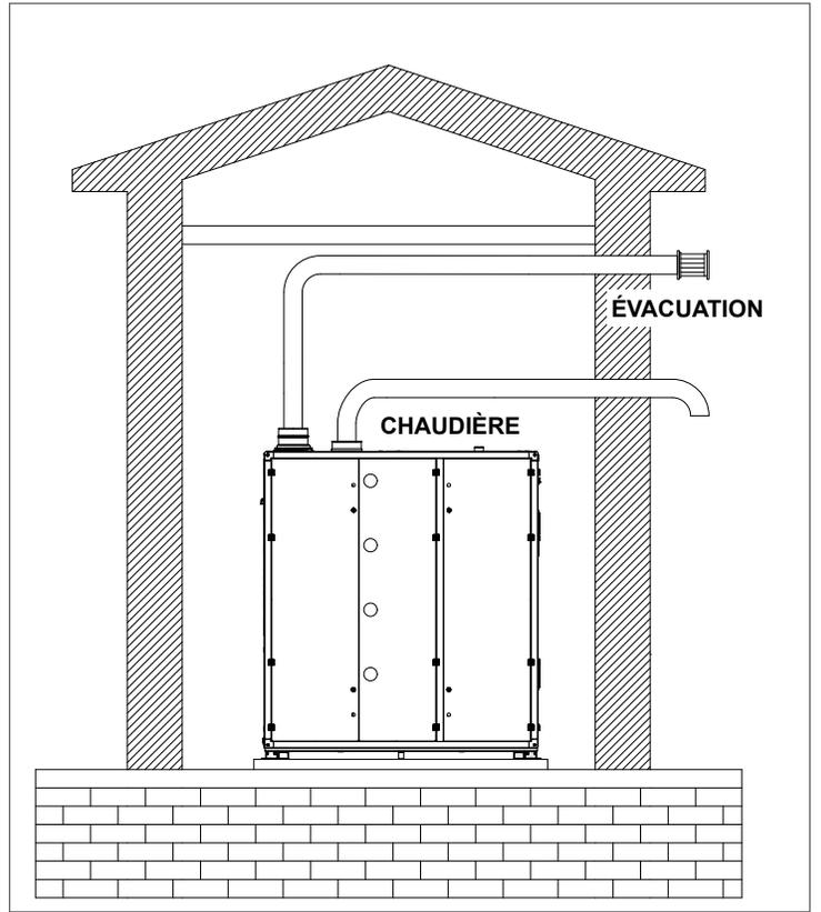
Fig. 41 *Prise d'air de combustion scellée située sur le même côté que la ventilation (horizontale)*
