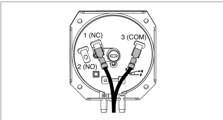
Fig. 76 Pressostat de gaz câblé
