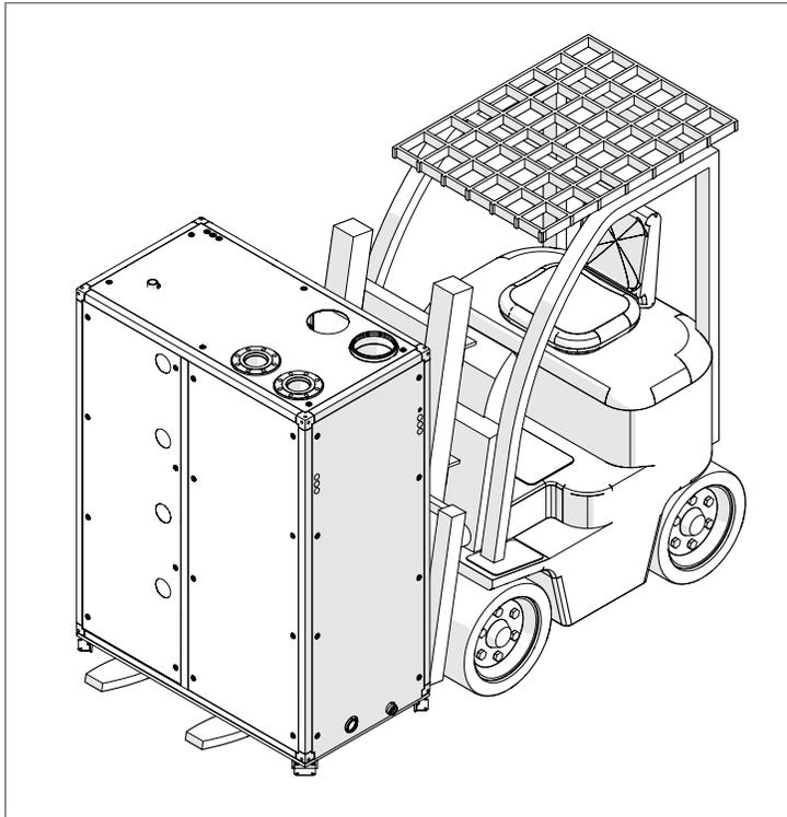
Fig. 5 Manutention par lève-palette des modèles AR 1000, AR 1500 et AR 2000
