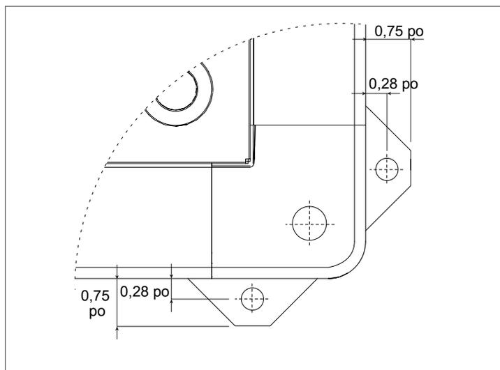
Fig. 10 Détail des boulons d'ancrage des modèles Array AR 1000, AR 1500 et AR 2000
