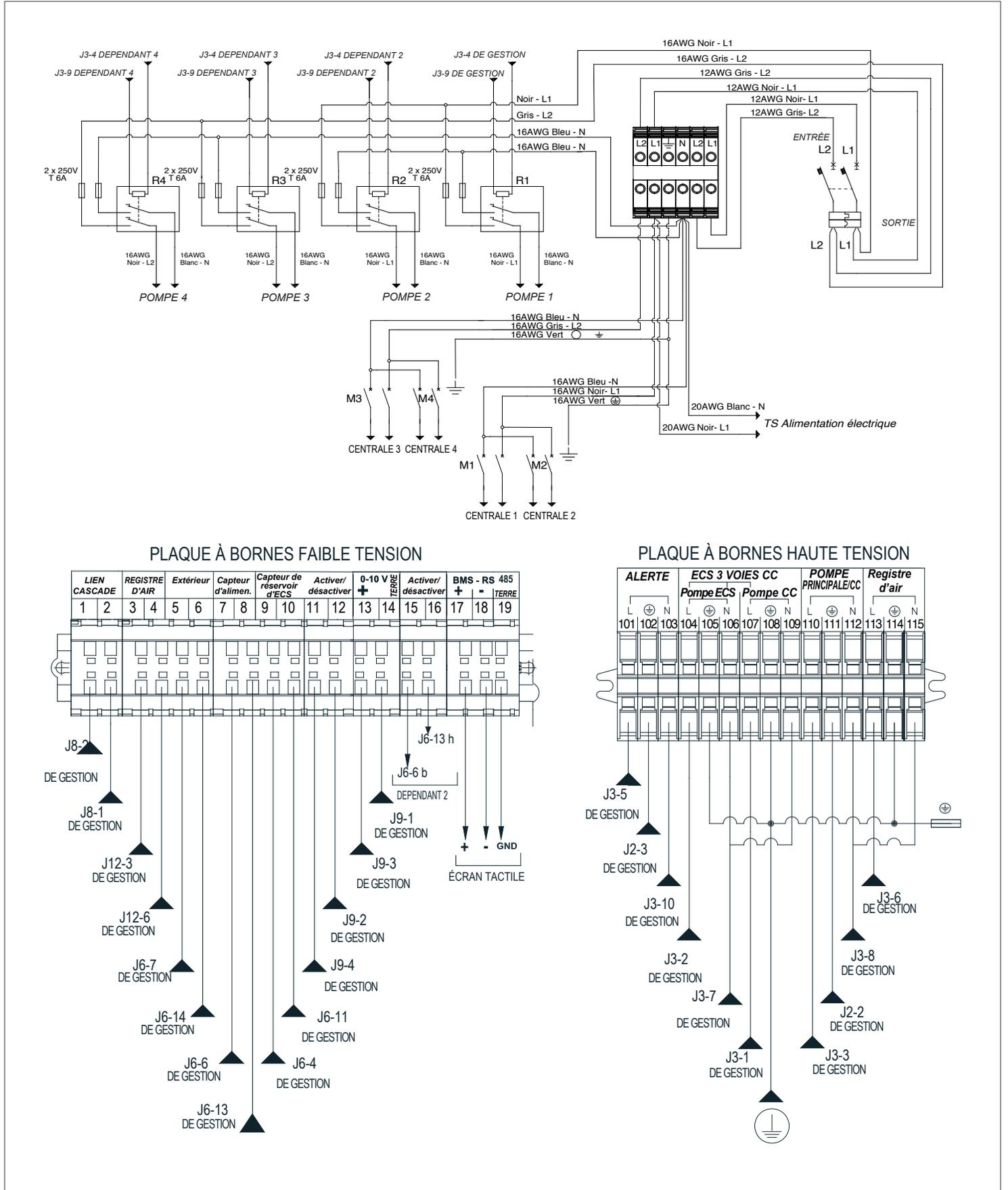
**SCHEMA DE CÂBLAGE DE LA CHAUDIÈRE AR 2000 – CHAUDIÈRE DE GESTION**
