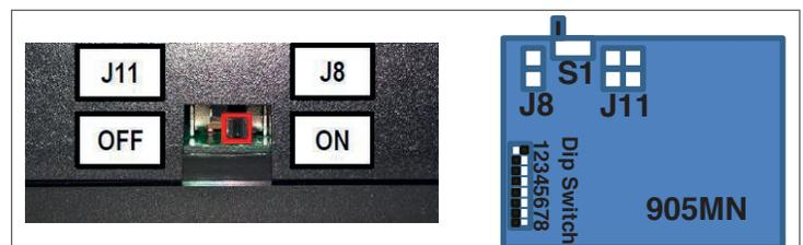
Fig. 60 Réglage du sectionneur S1
