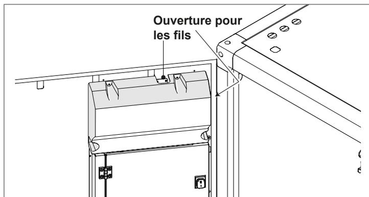
Fig. 32 Ouverture sur le panneau de couvercle
