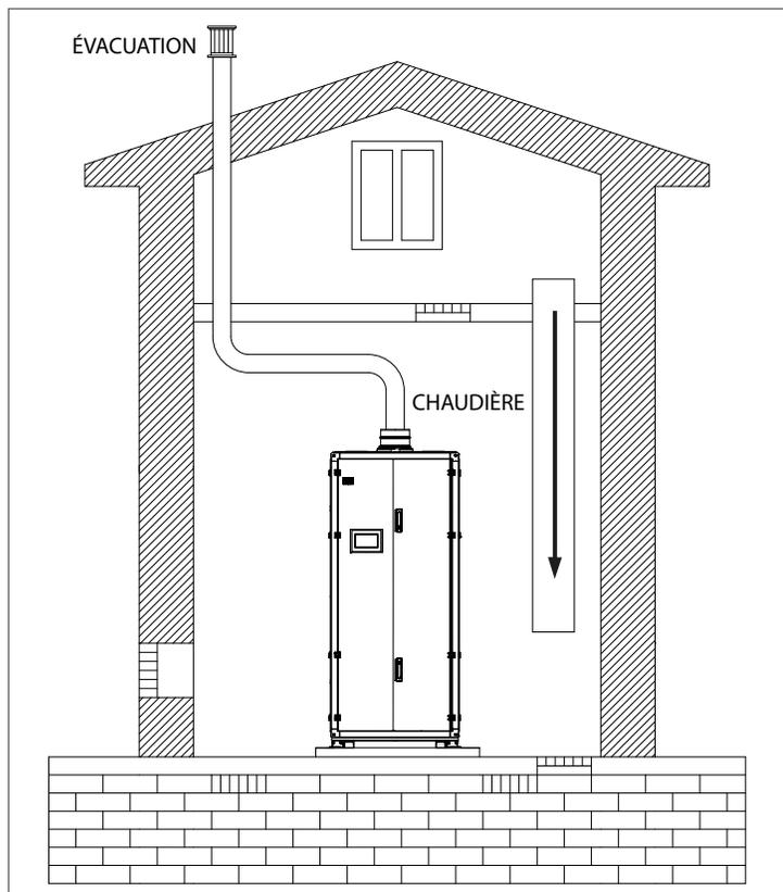
Fig. 36 *Tout l'air de combustion provient de l'extérieur par un grenier ventilé*
