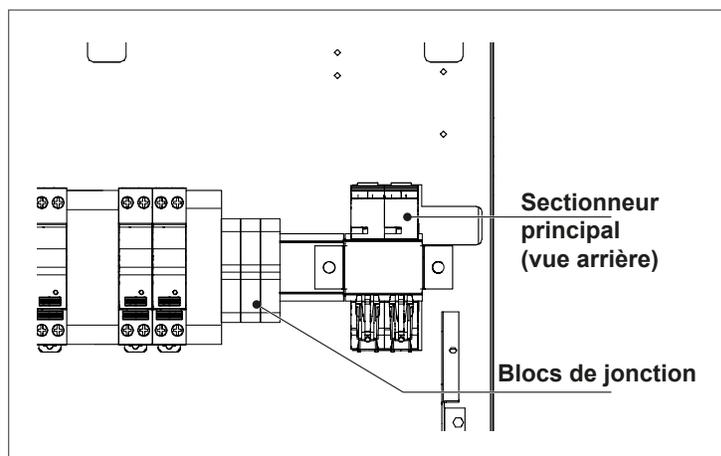
Fig. 23 Composantes électriques de la porte avant des chaudières AR 1000 et AR 1500
