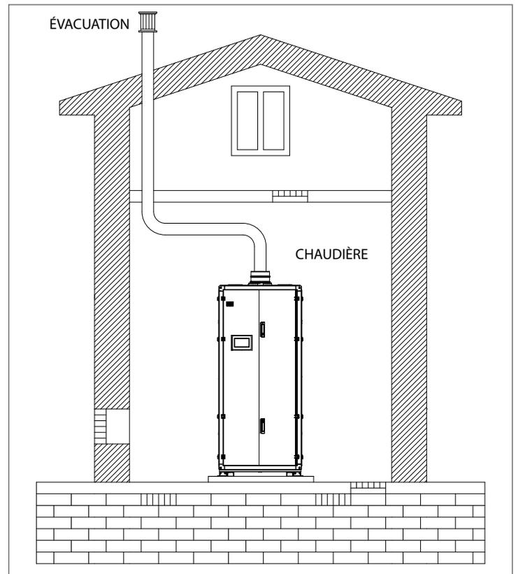
Fig. 37 *Tout l'air de combustion provient de l'extérieur – prise d'air par le vide sanitaire et ventilation vers un grenier ventilé*
