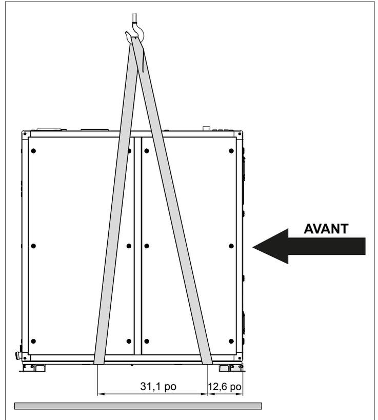
Fig. 6 Manutention lors du levage par grue des modèles AR 1000 et AR 1500
