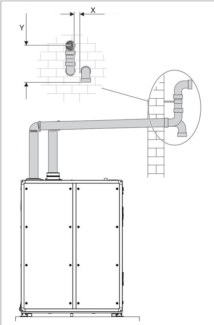
*Système de ventilation horizontale (combustion scellée) :*
