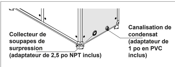
Fig. 14 Emplacement de la canalisation de condensat et du collecteur de soupapes de surpression
