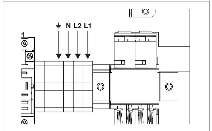
Fig. 29 Connexion à l'alimentation électrique de 230 V de la chaudière AR 2000
