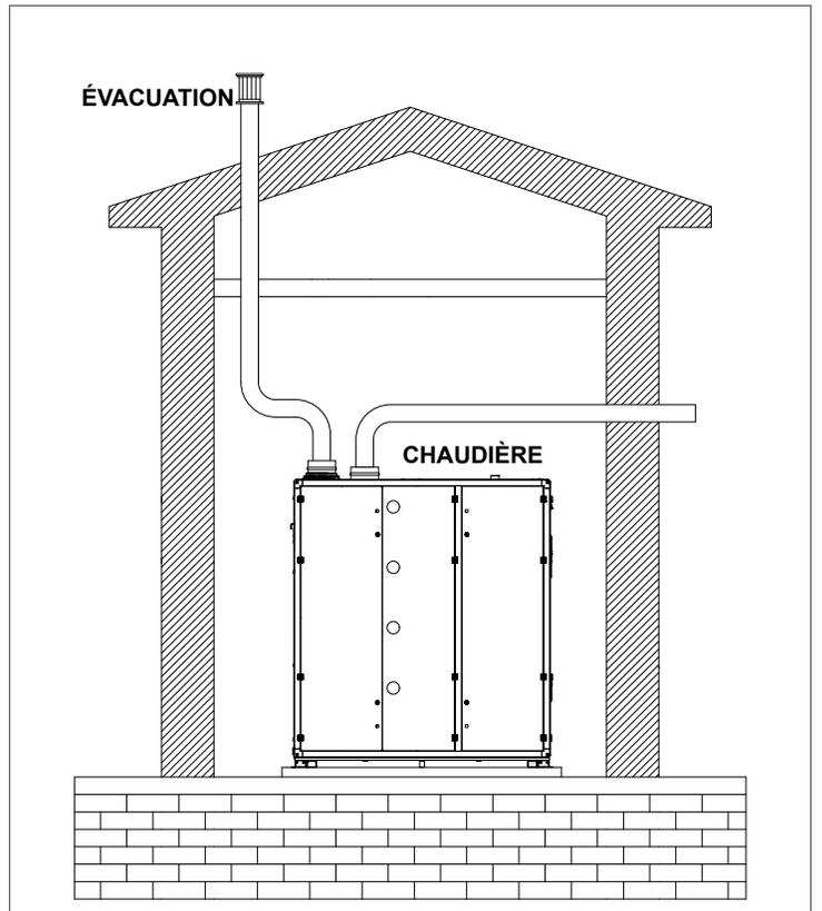
Fig. 42 *Prise d'air de combustion scellée sur mur latéral*
