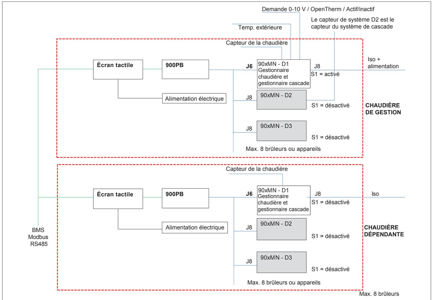
Fig. 59 Schéma d'installation de cascade
