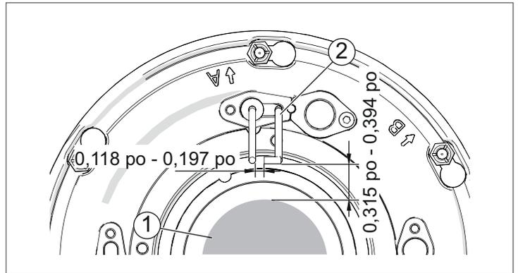
Fig. 70 Inspection de l'électrode d'allumage
