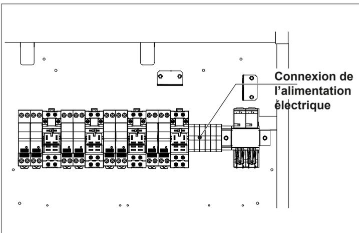
Fig. 27 Connexion à l'alimentation électrique de la chaudière AR 2000
