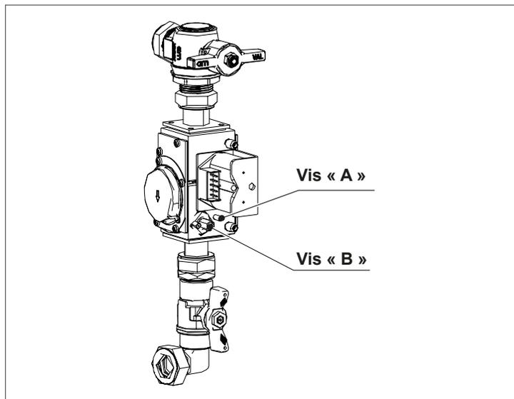
Fig. 20 Ajustement de l'O<sub>2</sub>
