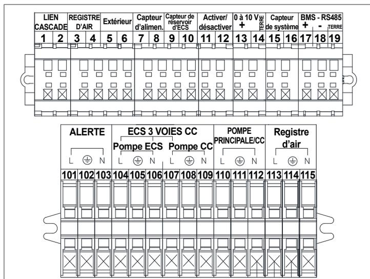
Fig. 31 Plaques à bornes E/S
