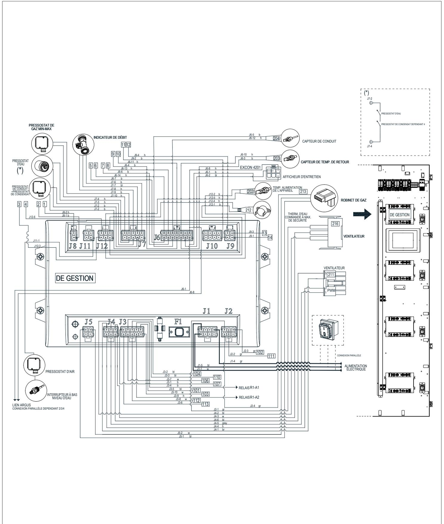
SCHÉMA DE CÂBLAGE DE LA CHAUDIÈRE AR 2000 – CHAUDIÈRE DÉPENDANTE 2/3/4
