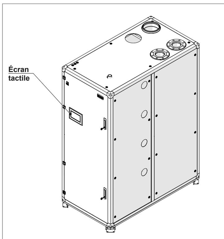
Fig. 61 Panneau de commande à écran tactile
