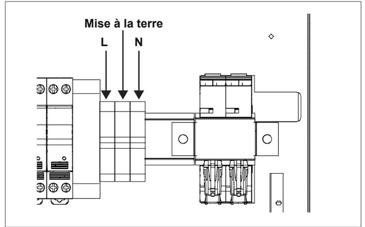
Fig. 28 Connexion à l'alimentation électrique de 120 V des chaudières AR 1000 et AR 1500
