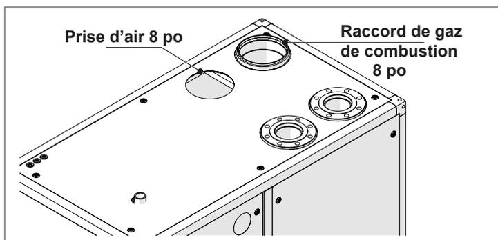
Fig. 34 Raccords d'air de combustion et de gaz de combustion de la chaudière AR 2000
