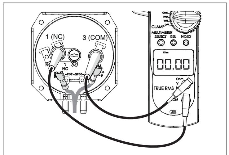
Fig. 74 Connecter les sondes du multimètre
