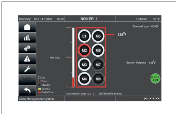
Fig. 64 Écran Boiler (chaudière)
