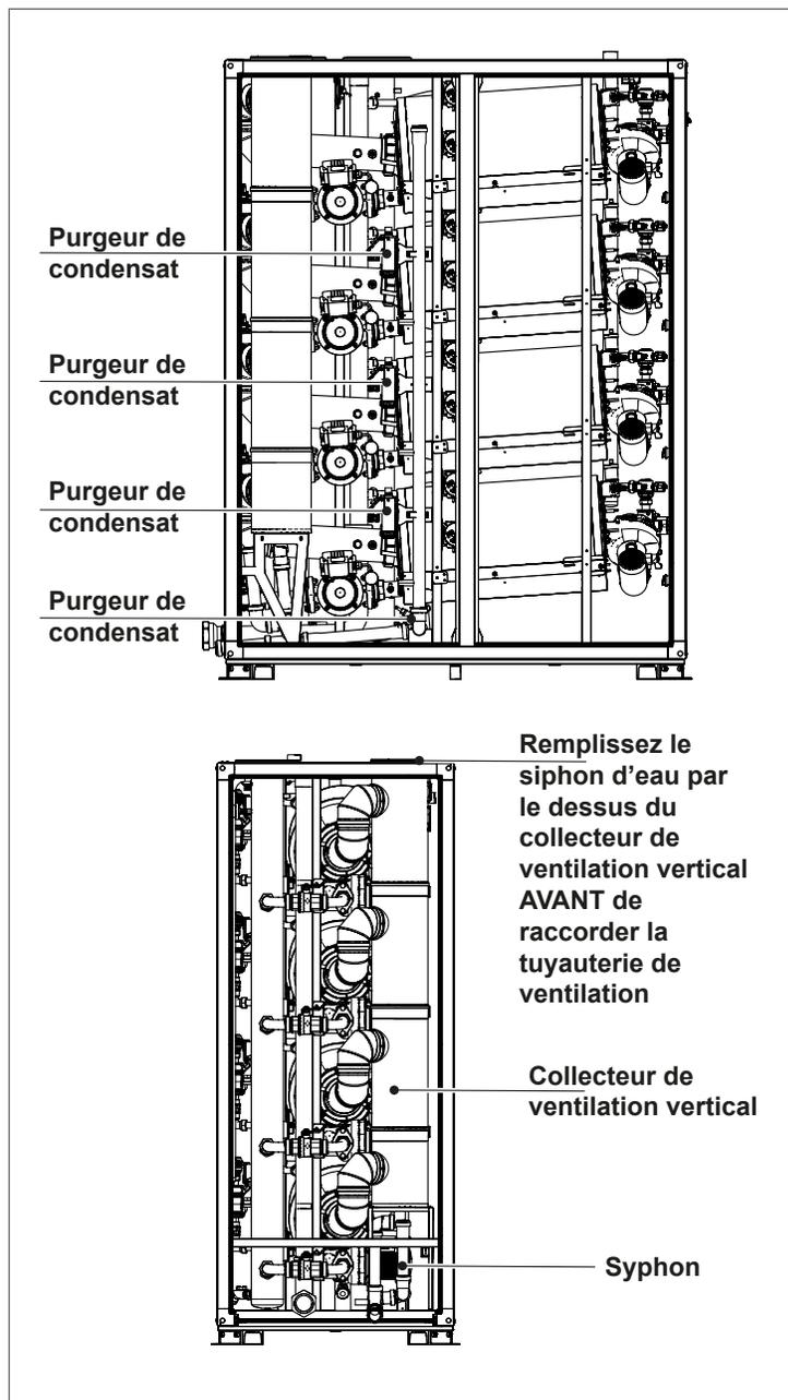
Fig. 13 Système de vidange de condensat
