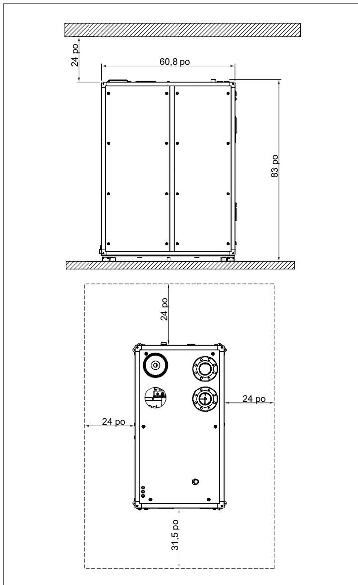
Fig. 4 Dégagements de la chaudière Array AR 2000
