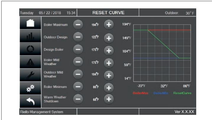
Fig. 50 Écran *Reset Curve* (courbe de réinitialisation)
