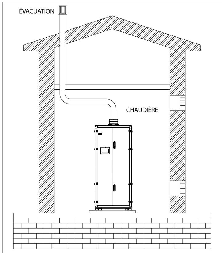
Fig. 35 *Tout l'air de combustion provient des espaces intérieurs adjacents par des ouvertures d'air de combustion intérieures*
