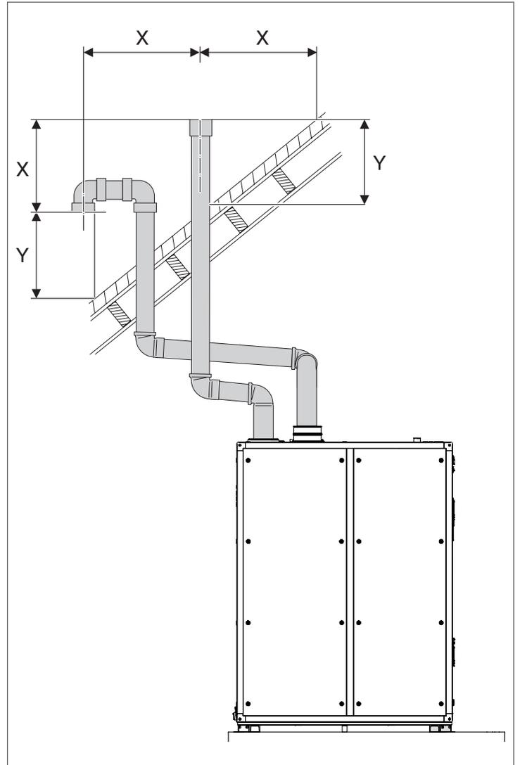
*Système de ventilation vertical (combustion scellée) :*
