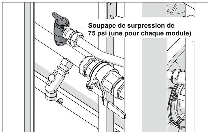
Fig. 12 Emplacement de la soupape de surpression
