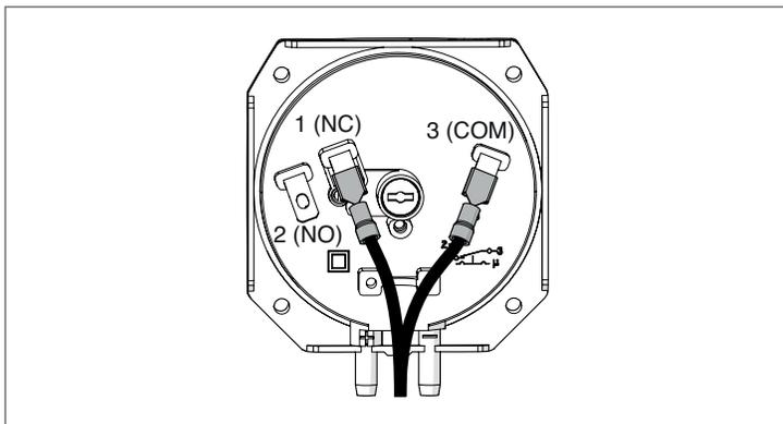
Fig. 71 Pressostat de gaz câblé
