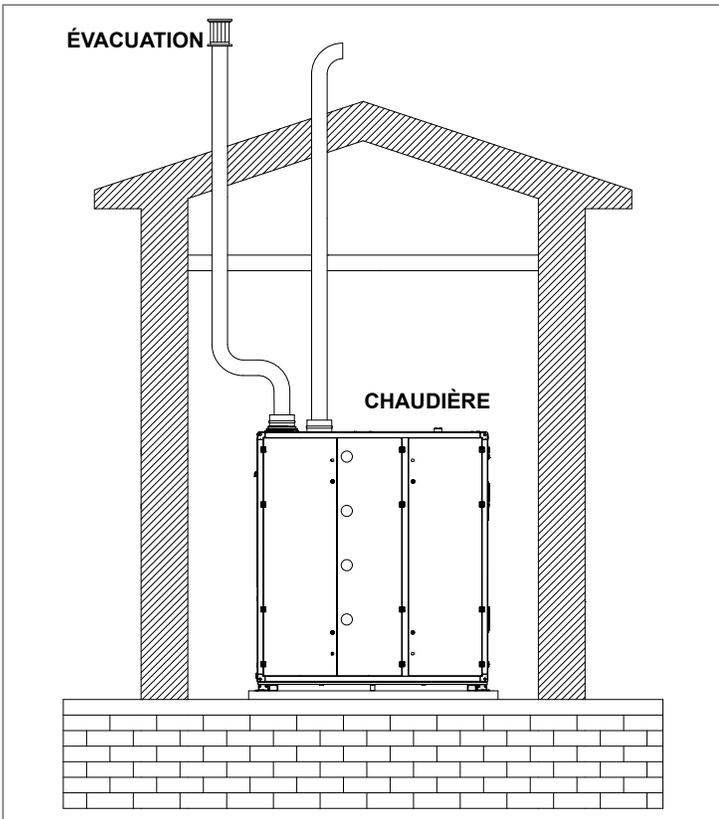
Fig. 40 *Prise d'air de combustion scellée située sur le même côté que la ventilation (verticale)*
