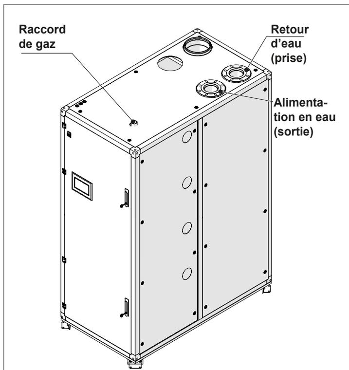
Fig. 11 Raccords des modèles Array AR 1000, AR 1500 et AR 2000
