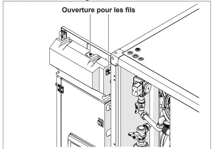
Fig. 25 Ouverture sur le panneau de couvercle
