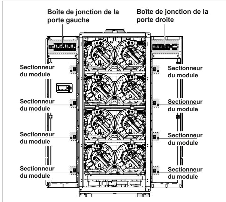
Fig. 18 Boîtes de jonction des portes avant
