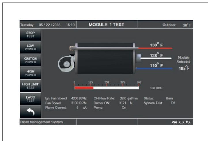
Fig. 61 Écran *Module test* (essai de module)
