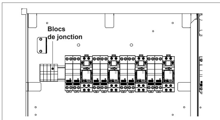
Fig. 20 Composantes électriques de la porte avant droite de la chaudière
