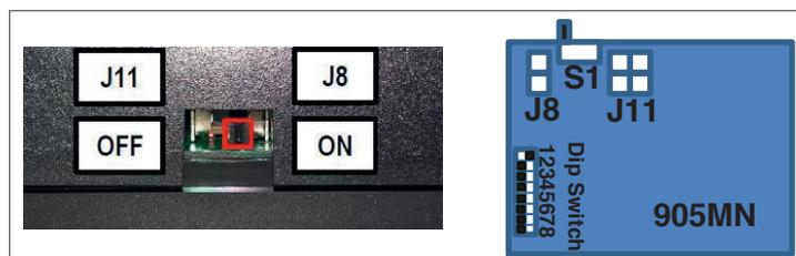
Fig. 52 Réglage du sectionneur S1
