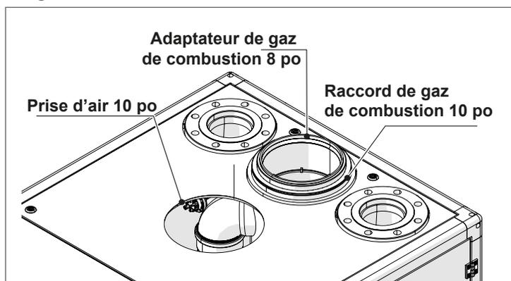
Fig. 26 Raccords d'air de combustion et de gaz de combustion de la chaudière
