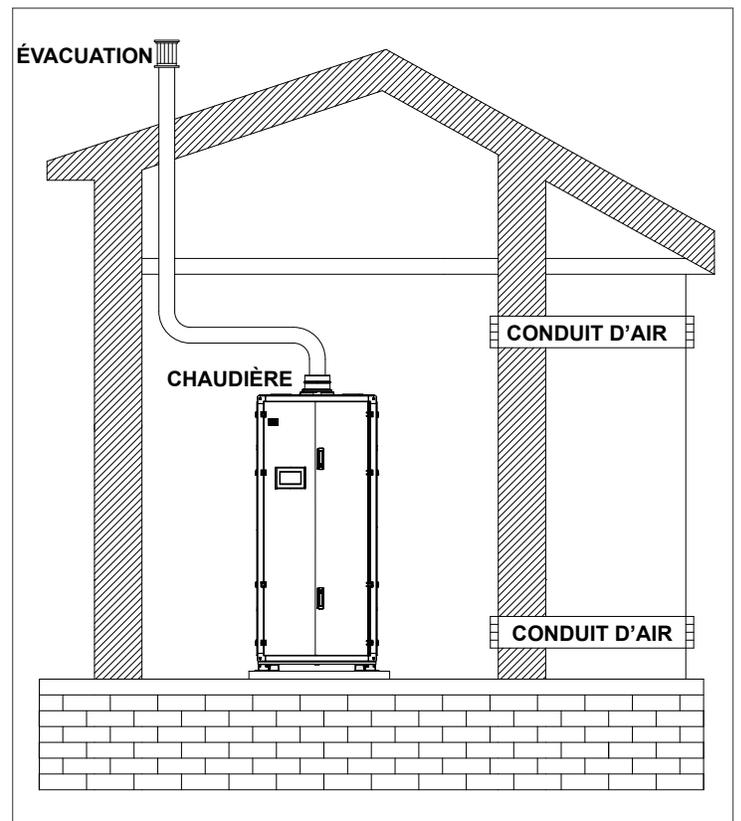
Fig. 30 *Tout l'air de combustion provient de l'extérieur par des conduits horizontaux*
