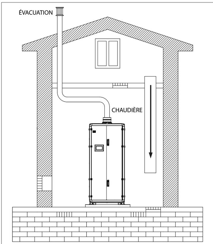
Fig. 28 *Tout l'air de combustion provient de l'extérieur par un grenier ventilé*
