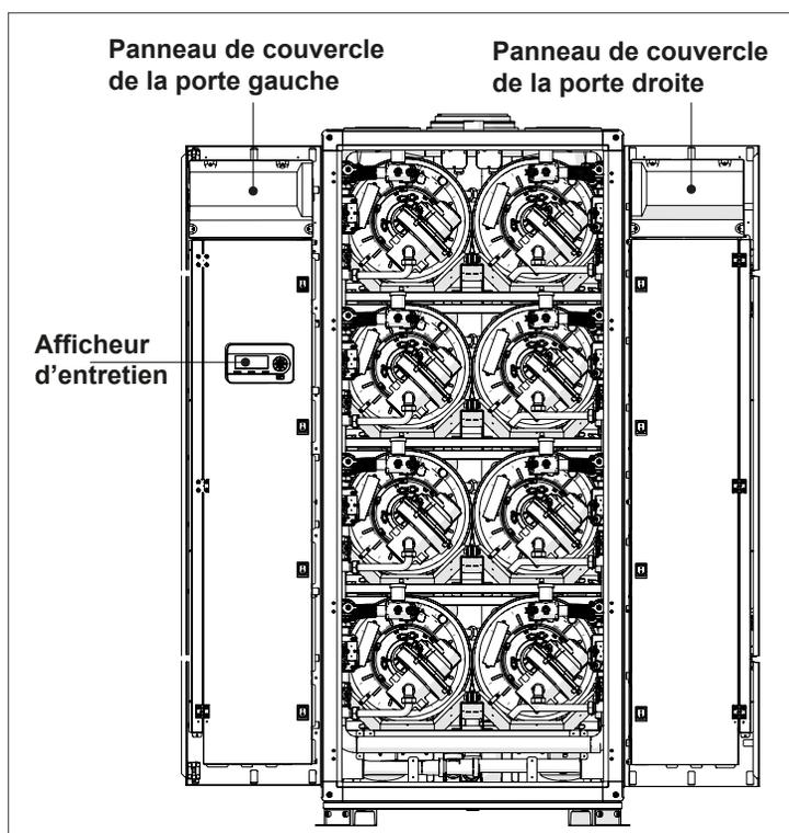
Fig. 17 Disposition interne des portes avant
