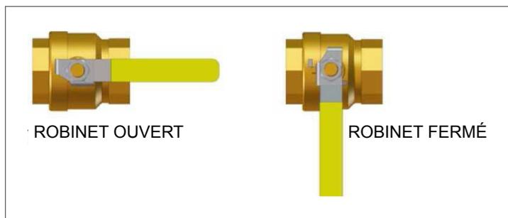
Fig. 2 Robinet de sectionnement de gaz manuel
