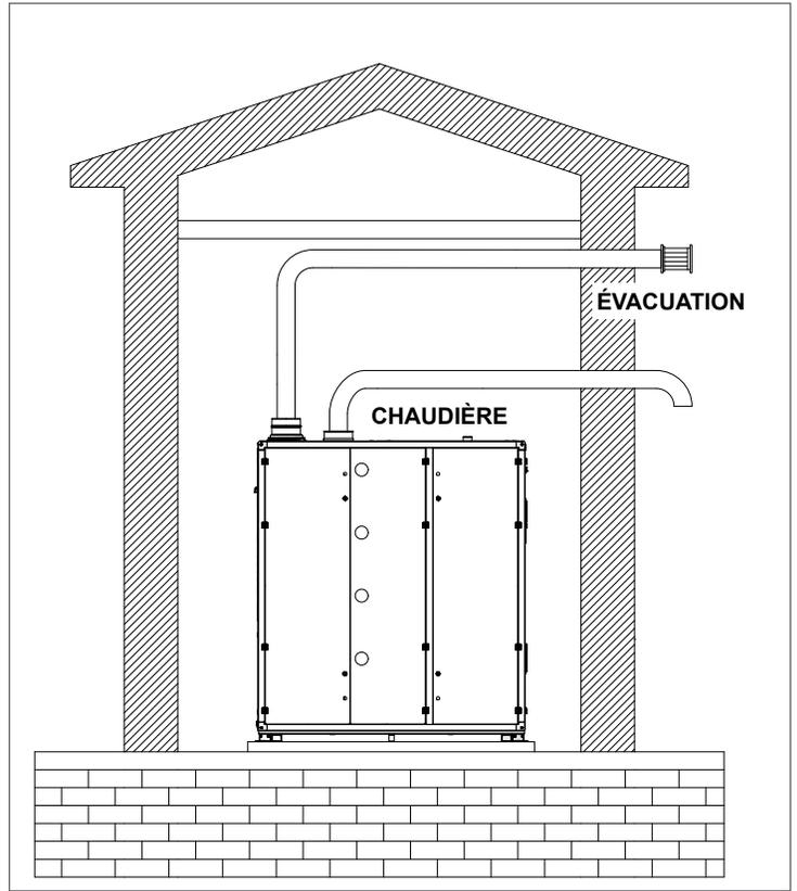
Fig. 33 *Prise d'air de combustion scellée située sur le même côté que la ventilation (horizontale)*
