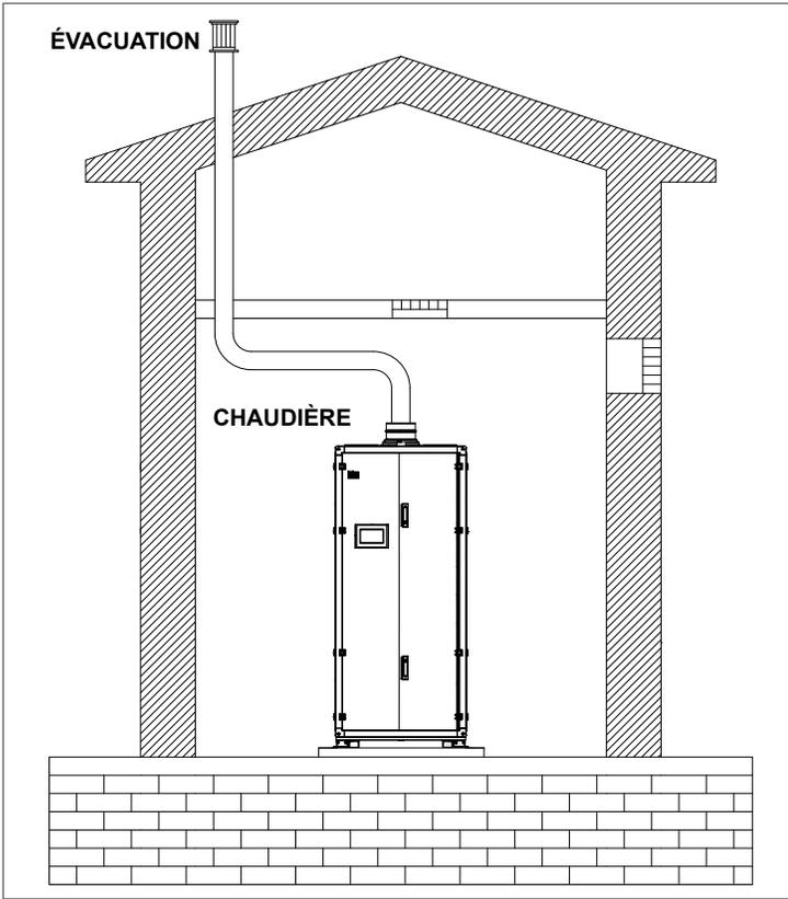
Fig. 31 *Tout l'air de combustion provient de l'extérieur par une seule ouverture d'air de combustio*
