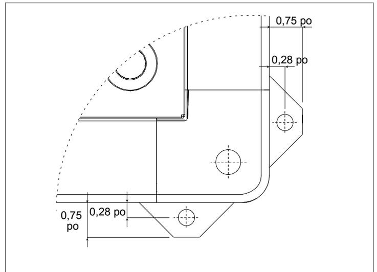
Fig. 8 Détail du boulon d'ancrage des chaudières Array AR 3000 et AR 4000
