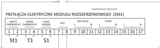
PRZYŁĄCZA ELEKTRYCZNE MODUŁU ROZSZERZENIOWEGO (ZM1)
