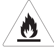
Riesgo de incendio/ materiales inflamables
