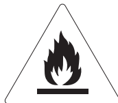
Risque d'incendie/ matières inflammables
