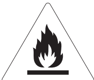
Rischio di incendio/ materiali infiammabili
