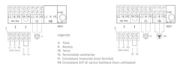
NOTA: Per collegare il termostato ambiente è necessario eliminare il ponticello (TA-TA) presente sulla morsettiera E.
