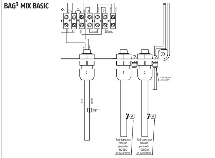
**!** I termostati ambiente (TA) e/o cronotermostati (CT) dell'impianto a bassa e alta temperatura devono essere collegati direttamente al **BAG<sup>3</sup>** utilizzando un cavo con sezione minima di 1 mm<sup>2</sup>.
