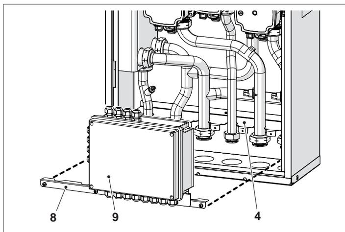
**!** Il modulo idraulico è fornito già cablato alle utenze del modulo stesso. Per altri collegamenti fare riferimento agli schemi elettrici presenti in questo documento (vedere "1.9 Schemi elettrici" page 7).
