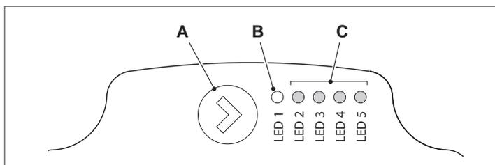
L'interfaccia utente permette di visualizzare le prestazioni in funzionamento (stato funzionamento e stato allarme) e impostare le modalità di funzionamento del circolatore. Le prestazioni, indicate dai LED (B) e (C) sono sempre visibili durante il normale funzionamento del circolatore mentre le impostazioni si effettuano con la pressione del tasto (A).
