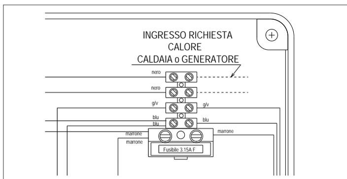
**!** Collegare il mammut (B-B) del **BAG<sup>3</sup>** al mammut (TA) della caldaia utilizzando un cavo min 2x0,5 mm<sup>2</sup> (riferirsi allo schema elettrico sul libretto istruzioni per l'installatore della caldaia specifica).
