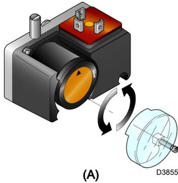
最低空气压力开关
