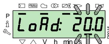
Soltando la tecla “F” aparece la visualización estándar con el porcentaje de carga actual parpadeando: esto significa que el quemador está funcionando en manual (se excluye cualquier regulación externa, solamente están activos los dispositivos de seguridad).
