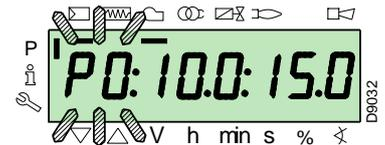
Para el servomotor del combustible, mantener presionado el pulsador “F” (la posición en grados parpadea) y presionar los pulsadores “+” o “-” para incrementar o disminuir el valor.
