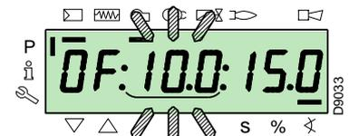
Para el servomotor del aire, mantener presionado el pulsador “A” (la posición en grados parpadea) y presionar los pulsadores “+” o “-” para incrementar o disminuir el valor.
