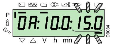
Para regular la velocidad del inverter (expresada en % es decir 50 Hz = 100 %), mantener presionadas simultáneamente las teclas “F” y “A” la posición en porcentaje parpadea y presionar las teclas “+” o “-” para incrementar o disminuir el valor.
