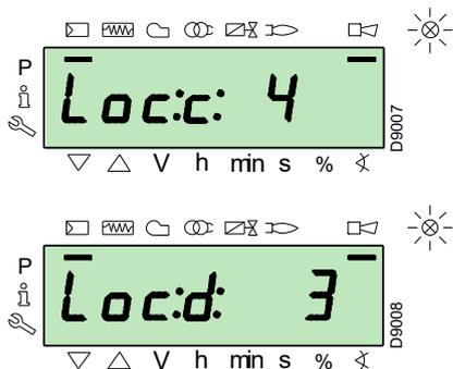
Para desbloquear presionar la tecla "i/reset" durante 1 seg: en el display aparece "rESET". Al soltar la tecla desaparecerá la señal de bloqueo y se apagará el indicador luminoso rojo. La caja de control está desbloqueada.
