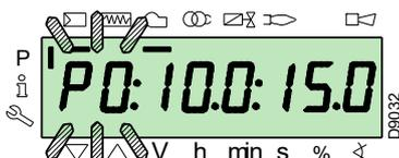
Para el servomotor del combustible, mantener presionada la tecla "F" (la posición en grados parpadea) y presionar las teclas "+" o "-" para aumentar o disminuir el valor.
