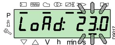
Para salir del modo manual presionar al mismo tiempo las teclas "+" y "-" (ESC) durante 3 segundos: el quemador funcionará en modo automático y la potencia dependerá del termostato/presostato de regulación (TR).
