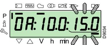
Para regular la velocidad del inverter (expresada en % es decir 50 Hz = 100 %), mantener presionadas simultáneamente las teclas "F" y "A" la posición en porcentaje parpadea y presionar las teclas "+" o "-" para incrementar o disminuir el valor.
