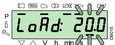
Soltando la tecla "F" aparece la visualización estándar con el porcentaje de carga actual parpadeando: esto significa que el quemador está funcionando en manual (se excluye cualquier regulación externa, solamente están activos los dispositivos de seguridad).
