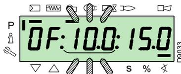
Para el servomotor del aire, mantener presionado la tecla "A" (la posición en grados parpadea) y presionar las teclas "+" o "-" para aumentar o disminuir el valor.
