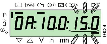
Para regular la velocidad del inverter (expresada en % es decir 50 Hz = 100 %), mantener presionadas simultáneamente las teclas "F" y "A" la posición en porcentaje parpadea y presionar las teclas "+" o "-" para incrementar o disminuir el valor.
