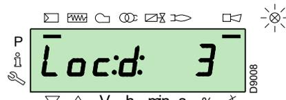
La pantalla visualiza alternadamente un código y una diagnosis de error, que no conduce al sistema a seguridad.
