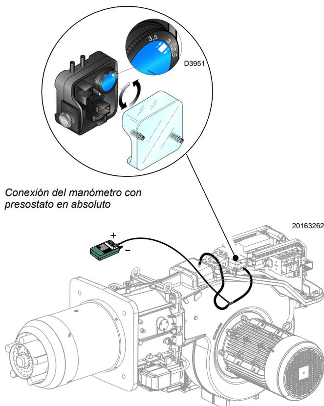
Conexión del manómetro con presostato en absoluto
