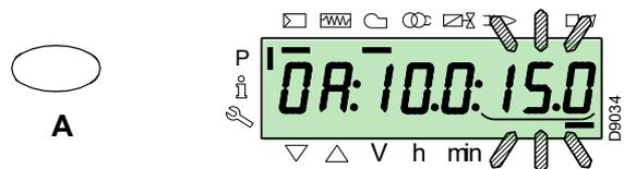
Para ajustar la velocidad del inverter (expresada en %, es decir, 50 Hz = 100 %), mantener presionadas las teclas "F" y "A" simultáneamente, la posición en porcentaje parpadea y presionar las teclas "+" o "-" para aumentar o disminuir el valor.
