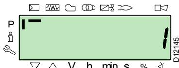
Después de unos 8 segundos (dependiendo de la duración del programa), el valor 0 aparece en la pantalla e identifica que el proceso de restore ha finalizado correctamente.
