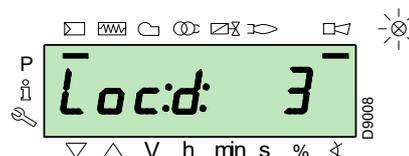
La pantalla muestra alternativamente un código y un diagnóstico de error, que no pone el sistema en condición de seguridad.
