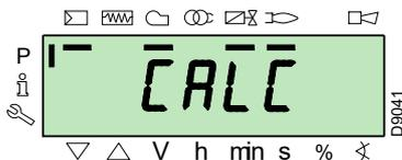
La caja de control restaurará automáticamente los mismos valores configurados en los puntos "P0" y "P1" a los puntos de "P2" a "P8".
