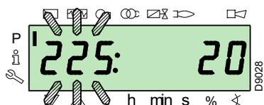
Si no se visualiza el valor, presionar la tecla "i/reset" durante un tiempo entre 1 y 3 segundos.
