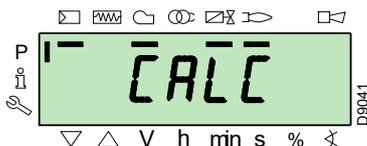
La caja de control calculará automáticamente los puntos de "P8" a "P2", distribuyéndolos en línea recta. Son teóricos y deben ser comprobados.
