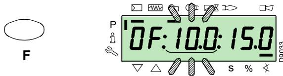
Para el servomotor aire, mantener presionada la tecla "A" (la posición en grados parpadea) y presionar las teclas "+" o "-" para aumentar o disminuir el valor.
