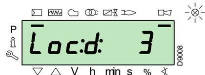
El display visualiza alternadamente un código y una diagnosis de error, que no conduce al sistema a seguridad.
