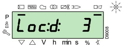
Para desbloquear presionar la tecla "i/reset" durante 1 seg: en el display aparece "rESEt". Al soltar la tecla desaparecerá la señal de bloqueo y se apagará el indicador luminoso rojo. La caja de control está desbloqueada.
