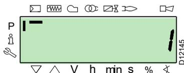
Después de aproximadamente 8 segundos (dependiendo de la duración del programa), en la pantalla se visualiza el valor 0 que indica que el proceso de restore ha finalizado correctamente.
