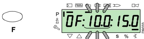
Para el servomotor del aire, mantener presionado la tecla "A" (la posición en grados parpadea) y presionar las teclas "+" o "-" para aumentar o disminuir el valor.
