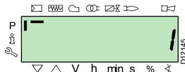
Después de aproximadamente 5 segundos (dependiendo de la duración del programa), en la pantalla se visualiza el valor **0** que indica que el proceso de backup ha finalizado correctamente.
