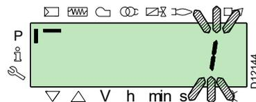
confirmar presionando la tecla "i/reset" para activar el proceso de **restore**.
