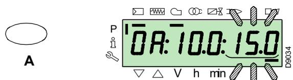
Para regular la velocidad del inverter (expresada en % es decir 50 Hz = 100 %), mantener presionadas simultáneamente las teclas "F" y "A" la posición en porcentaje parpadea y presionar las teclas "+" o "-" para incrementar o disminuir el valor.
