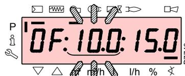
Para el servomotor del combustible, mantener presionado el pulsador “**F**” (la posición en grados parpadea) y presionar los pulsadores “**+**” o “**-**” para incrementar o disminuir el valor.
