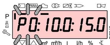
Utilizando los pulsadores “**+**” y “**-**” ingresar/seleccionar el punto de la curva deseado y esperar que el mismo parpadee: esto significa que los servomotores están colocados en los valores visualizados en el display y que corresponden al punto programado precedentemente.
