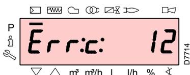
El display visualiza alternadamente el código de error (en el ejemplo del lado c: 12) y la diagnosis correspondiente (en el ejemplo d: 0).
