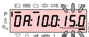
Para el servomotor del aire, mantener presionado el pulsador “**A**” (la posición en grados parpadea) y presionar los pulsadores “**+**” o “**-**” para incrementar o disminuir el valor.
