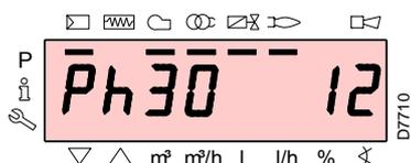
El display visualiza las diferentes fases del arranque, encendido y apagado del quemador.
