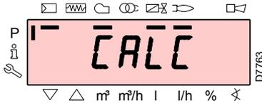
Después de la regulación del punto "P1" presionar el pulsador "+", en el display se visualiza "CALC" durante algunos segundos: la caja de control calculará automáticamente los puntos desde "P2" a "P8", distribuyéndolos en una recta, atribuyendo para el punto "P9" la programación de fábrica (véase la tabla reproducida abajo). Los mismos son teóricos y se deben verificar.
