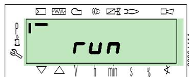
Confirmar presionando la tecla "i/reset". El quemador se pone en funcionamiento.
