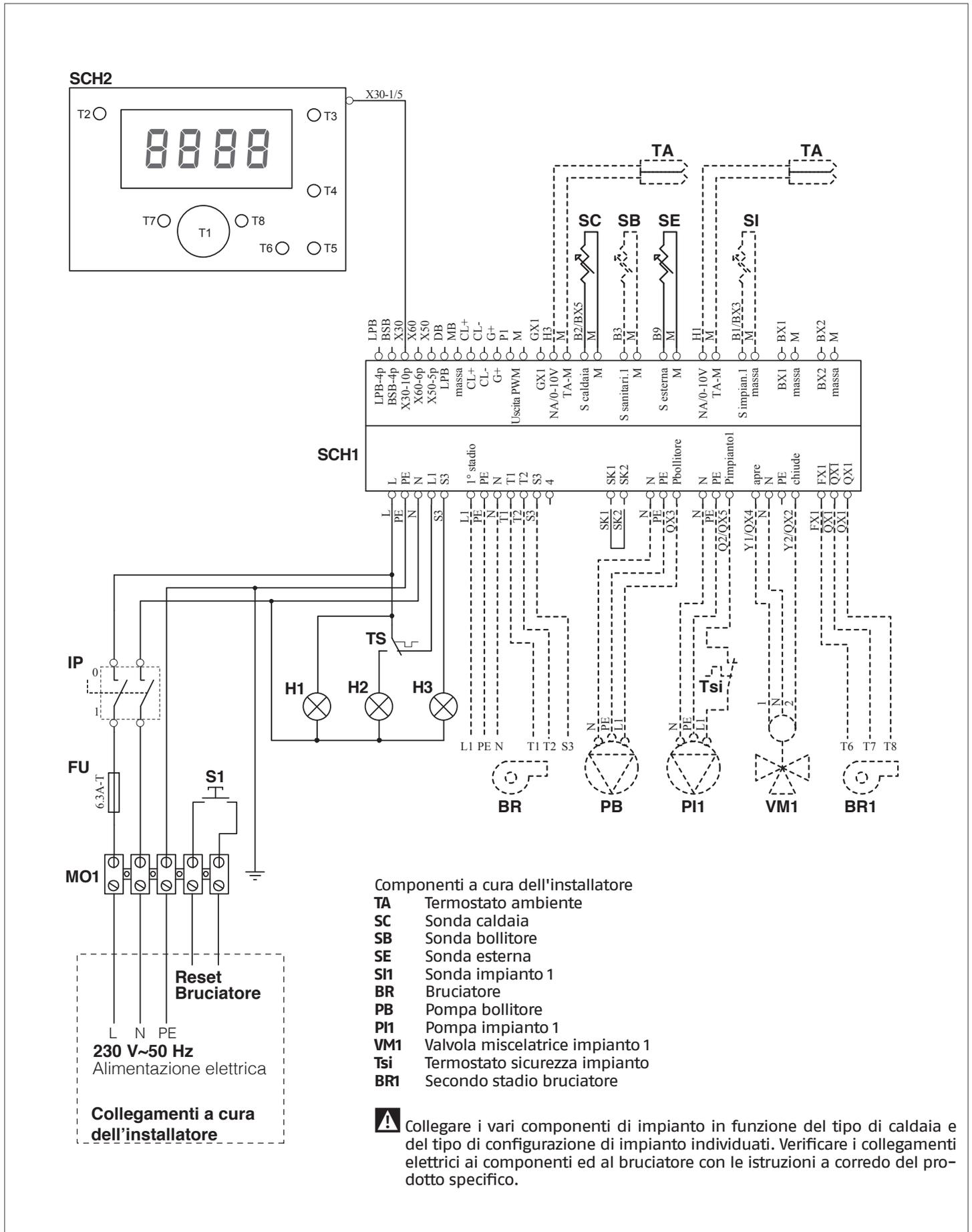
Esempio di schema elettrico di collegamento dei componenti di impianto con quadro elettrico RIELLOtech CLIMA COMFORT e bruciatore modulante
