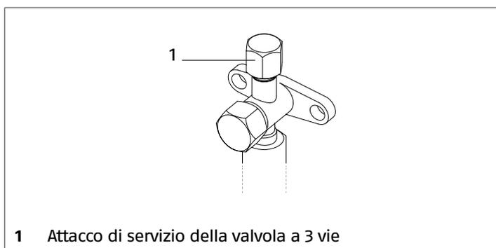
— caricare il circuito con azoto attraverso l'attacco di servizio presente sulla valvola d'intercettazione a 3 vie
