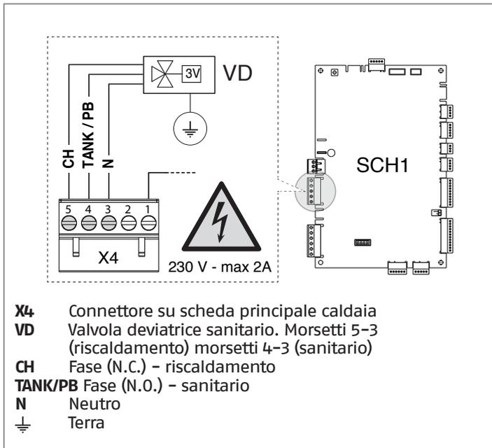
**Pompa bollitore PB (non fornita)**
