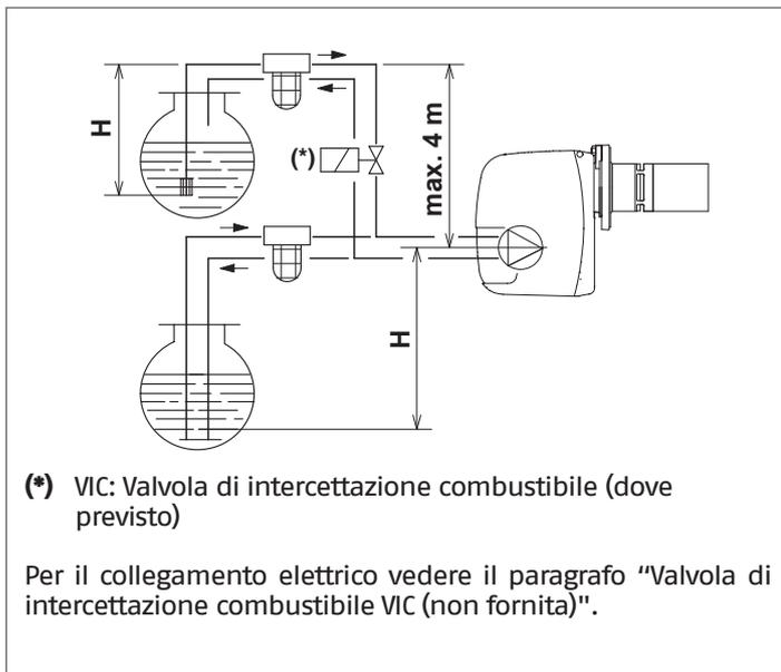
**⚠** Qualora sia prevista l'installazione di una valvola di intercettazione combustibile (VIC) nel circuito di alimentazione gasolio al bruciatore, la chiusura della valvola deve essere ritardata per evitare che il tratto di tubazione tra la pompa e la valvola vada in depressione (vuoto).
