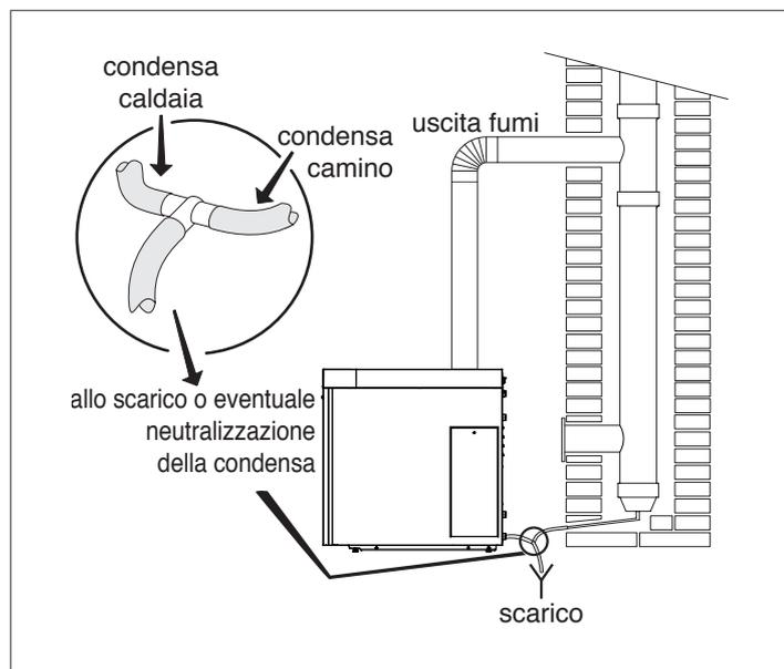
**⚠** Eventuali dispositivi di neutralizzazione della condensa potranno essere collegati dopo il sifone. Per il calcolo della durata della carica di neutralizzazione deve essere valutato lo stato di consumo del neutralizzatore dopo un anno di funzionamento. Sulla base di tale informazione si potrà estrapolare la durata totale della carica.
