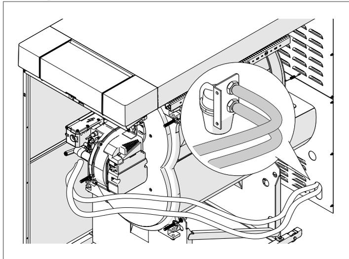
Il collegamento all'aspirazione della pompa gasolio deve essere eseguito direttamente sul filtro (1) (accessorio), il tubo di ritorno sul raccordo predisposto (2).
