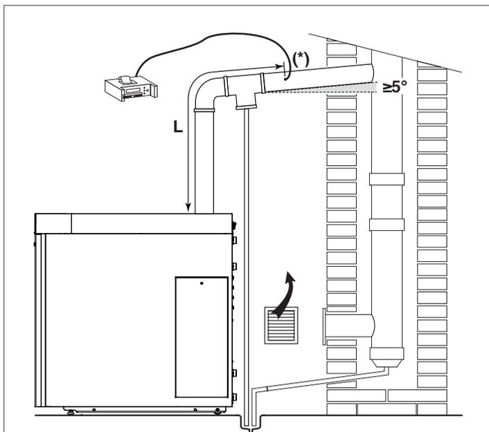
(\*) Il foro di prelievo per l'analisi fumi deve essere realizzato sul tratto rettilineo del condotto di scarico, sufficientemente lontano da curve o da gomiti. Per le dimensioni del foro e per conoscere la sua posizione corretta L sul condotto di scarico (distanza minima o massima da rispettare dall'uscita dell'apparecchio), fare riferimento alla normativa vigente.
