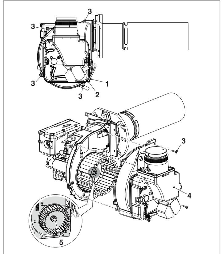
**⚠** Durante il rimontaggio del ventilatore è importante rispettare la posizione (B) e riavvitare la vite (5).
