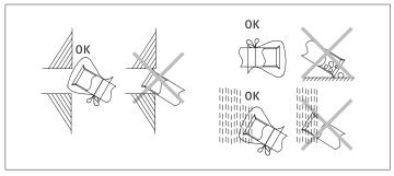
A Prima di inserire le linee attraverso il foro sul muro tappare le estremità.
